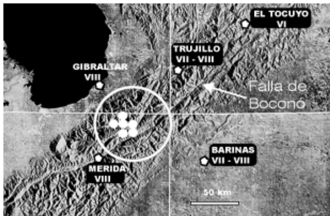
Figura 5. Ubicación en el mapa de radar de la región epicentral. Los puntos blancos corresponden a rms[M_i] < 0,05 y el círculo grande encierra con una confianza de aproximadamente 50% la región epicentral.
